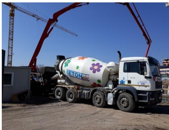
Slika 1. Autobetonska mešalica (mikser) zapremine bubenja  $9 \text{ m}^3$  na istovaru betona u prijemni koš autobetonske pumpe (fotografija: B. Matejević)
