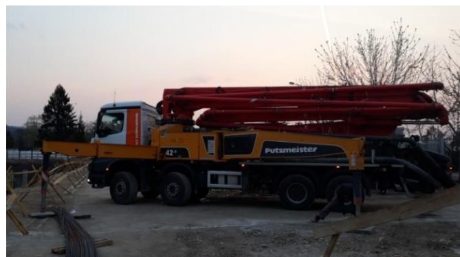
Slika 3. Autobetonska pumpa dužine strele 42 m, priprema za betoniranje (fotografija: B. Matejević)
