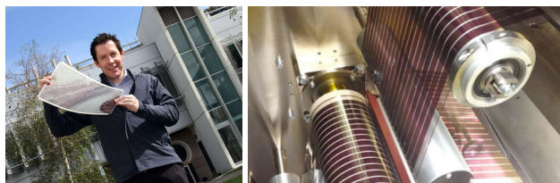
Slika 3 – Prikaz solarne ćelije nastale štampanjem na štampaču
