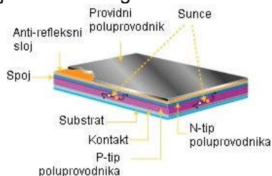
Slika 1 – Prikaz rada fotonaponske ćelije
