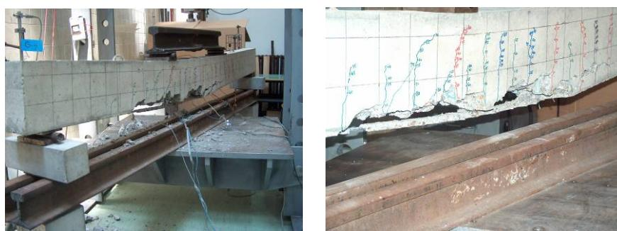
Slika 5: Dispozicija eksperimenta i način otkaza ojačanog nosača
