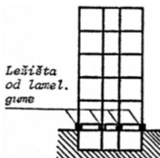
Slika 9 - Konstruisanje izolacionog sistema „Caspec“
