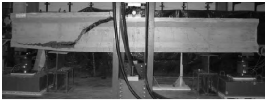
Slika 1. Lom po kosoj prslini kod grede bez poprečne armature
