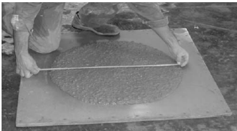
Slika 1. Slump-flow test
