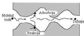
Slika 2. Načini kretanja i vezivanja molekula vode u suvim porama: adsorpcija za zidove pora, učestvovanje u procesima hidratacije i difuzija
