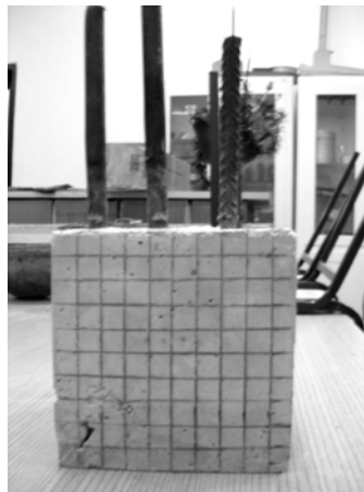
Slika 4. Izgled jednog betonskog tela sa ugrađenom armaturom
