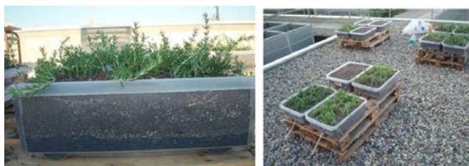
Slika 5. Eksperimentalni zeleni krovovi u posudama.
